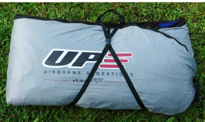
Der lange Schlauch wird mit dem UP Logo an der Außenseite zusammengeklappt und mit den am Zellenpacksack befestigten Außenbändern zusammen geklippt.
