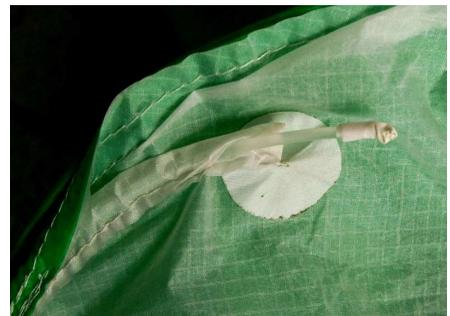
Dazu schiebt man das Stäbchen etwas zurück bis es aus der Tasche gleitet. Anschließend zieht man es heraus und überträgt die Länge exakt auf das Ersatzmaterial. Bevor der neue Stab eingesetzt werden kann, müssen seine Enden abgerundet und mit Gewebeklebeband abgeklebt werden. Beim Ein-
